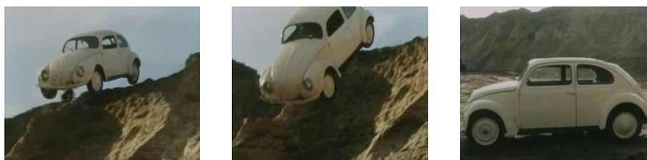
ABBILDUNG 4. Die Karosserie eines Volkswagen Käfer ist erstaunlich stabil. Das Bild rechts zeigt das Auto fast unversehrt nach einem vollen Überschlag.
