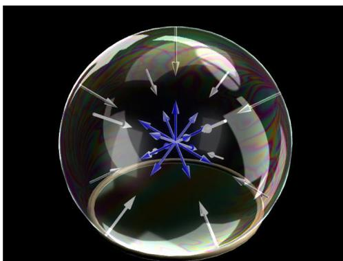
ABBILDUNG 8. Die Oberflächenspannung wirkt dem Gasdruck in der Seifenblase entgegen, und es herrscht Kräftegleichgewicht.
